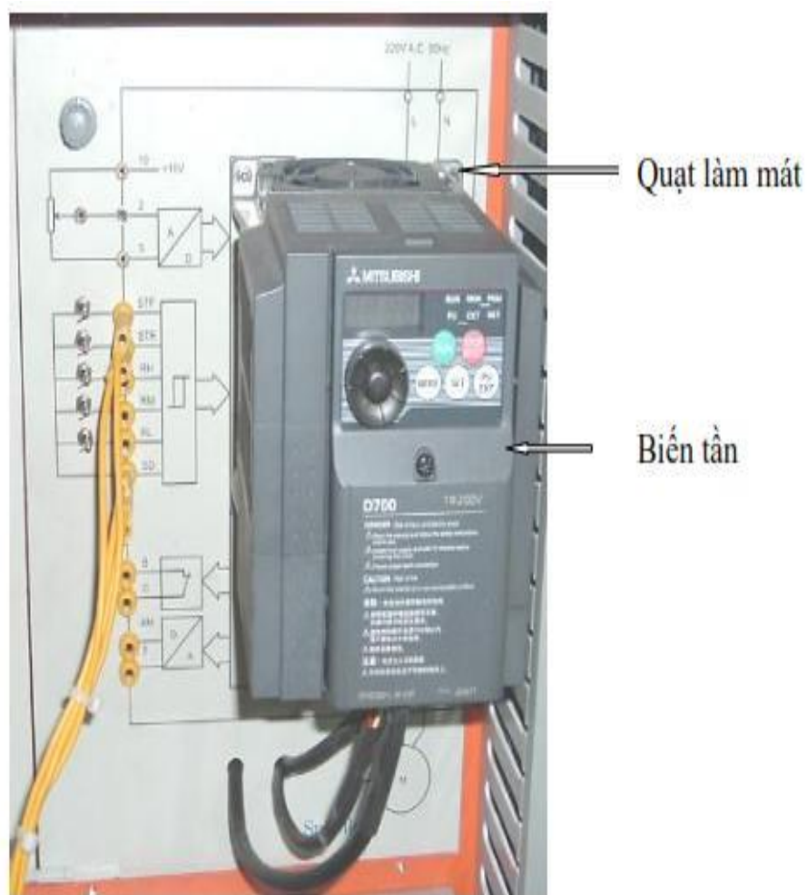
Hình 1. Sơ đồ khối điều khiển động cơ trực chính
